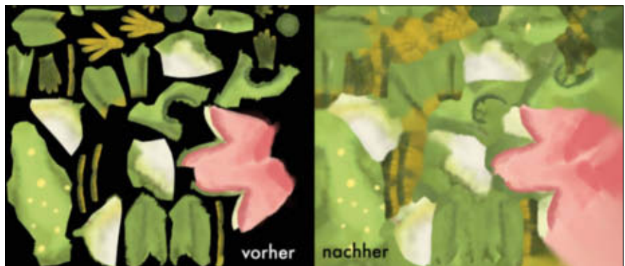
Randoptimierung Die Optimierung von Texturverläufen an den Rändern von UV-Patches zur Vermeidung von Bleeding-Effekten (in der Weiterverarbeitung mit CrazyBump)
