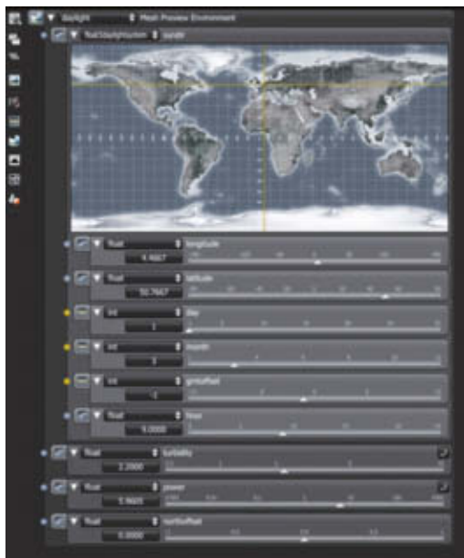
Mit dem Daylight-System lässt sich der Sonnenstand zu einer bestimmten Zeit an einem Ort simulieren.
