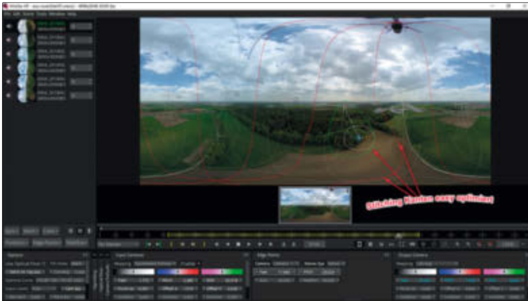
Mistika VR – Must-have Stitching Tool: dehnbare Stit- ching-Kanten lösen Probleme insbesondere bei Kalibrierungs- schwächen der Kameras oder wenn Nah- bereichslimits von Darstellern unterschritten wurden.
