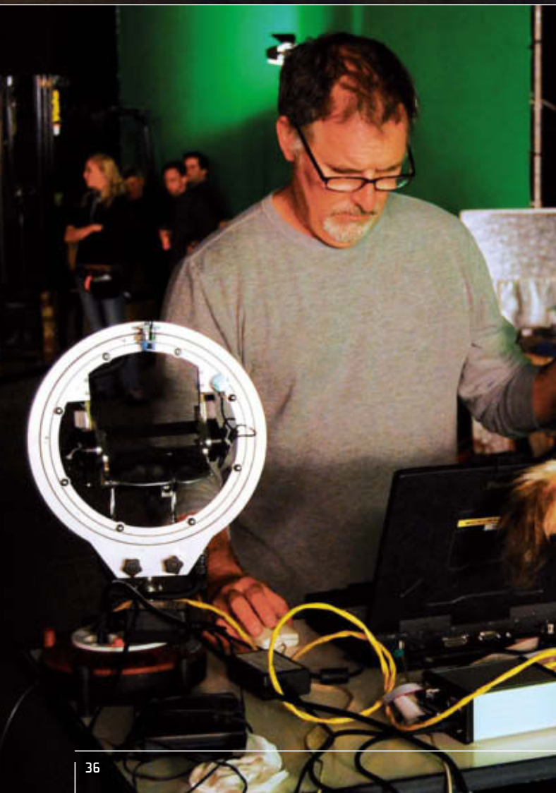
Der Animatronic-Kopf von Yoko ist ein komplexes Gerät, in dem 50 Mini-Motoren stecken. Die Darstellung des Yetis war für den Yoko-Schauspieler mit großer Anstrengung verbunden. Fido stellte das Animatronic in Stockholm her.
