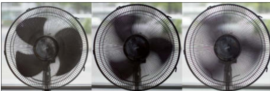
Links der normale Rolling Shutter, in der Mitte der Motion Mount mit der Einstellung „Square“ und rechts „Soft“.
