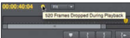
Schlapp gemacht – Der Knopf für Dropped Frames zeigt genau, wenn die Hardware nicht mitkommt.
