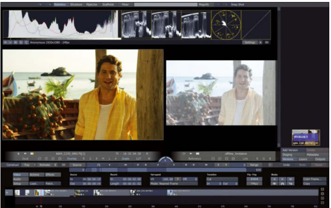
Im Dual View Mode können wir unsere conformte Timeline mit einem Referenz-File abgleichen.
