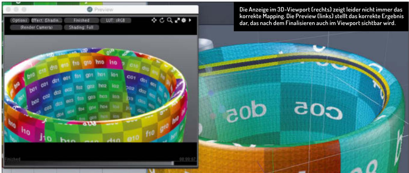
Die Anzeige im 3D-Viewport (rechts) zeigt leider nicht immer das korrekte Mapping. Die Preview (links) stellt das korrekte Ergebnis dar, das nach dem Finalisieren auch im Viewport sichtbar wird.
