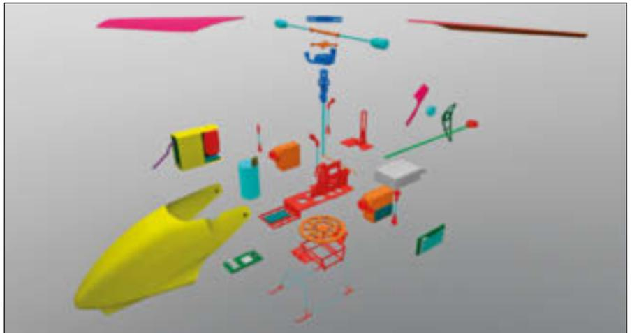
Abb. 2: Explosionszeichnung mit farblicher Unterscheidung der einzelnen Materialien
