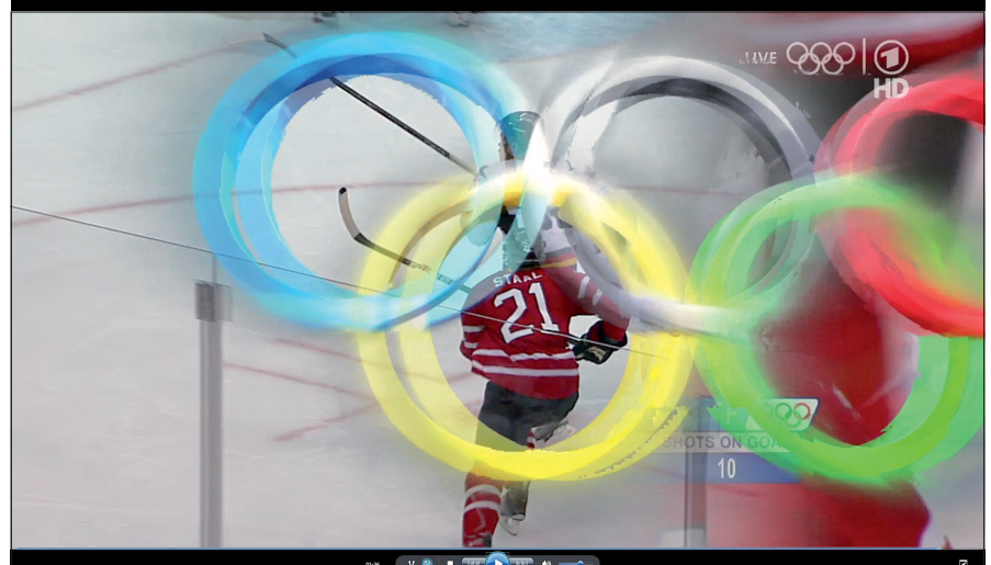
Logo ist zerstört: Ursache ist der Framerate-Konverter. Er produziert 1080i59, gesendet wurde 1080i50. Der Fehler gleicht solchen, die zum Beispiel bei 600-Hz-Consumer-TV-Geräten auftreten.
