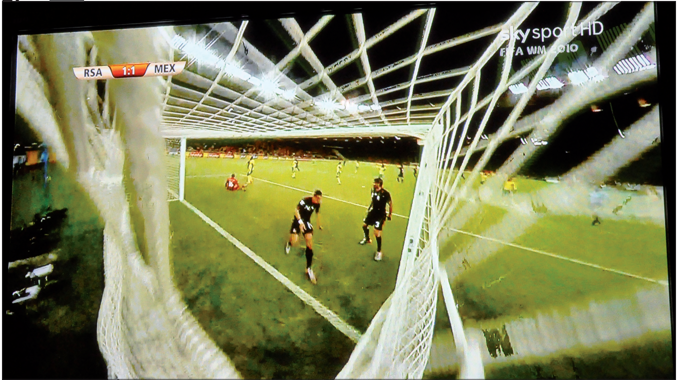
Die dunklen „Löcher“ im weißen Netz sind Artefakte eines billigen Deinterlacers. Dies kann der Monitor oder Fernseher sein, in dem Fall ging das so über den Sender.
