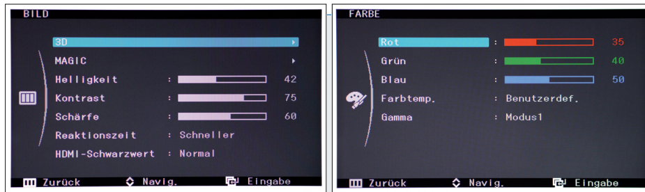
Anpassungsfähig: Mit diesen Einstellungen im Menü sollte man den Monitor vor der Kalibrierung so nah wie möglich an die Normwerte bringen.
