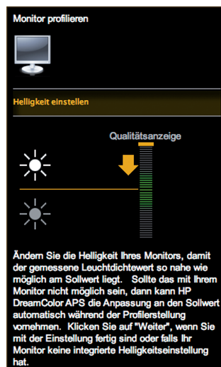
Nachgestellt: Auch die HP Software fordert vor der Kalibrierung zur manuellen Einstellung des Bildschirms auf (links). Brückenschlag: Der HD-Link von BlackMagic Design macht gute Computerbildschirme zu SDI- oder HDMI-Monitoren (oben).
